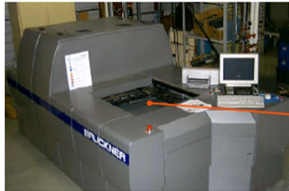
Biaxial stretcher apparatus (Karo IV from Bruckner)
